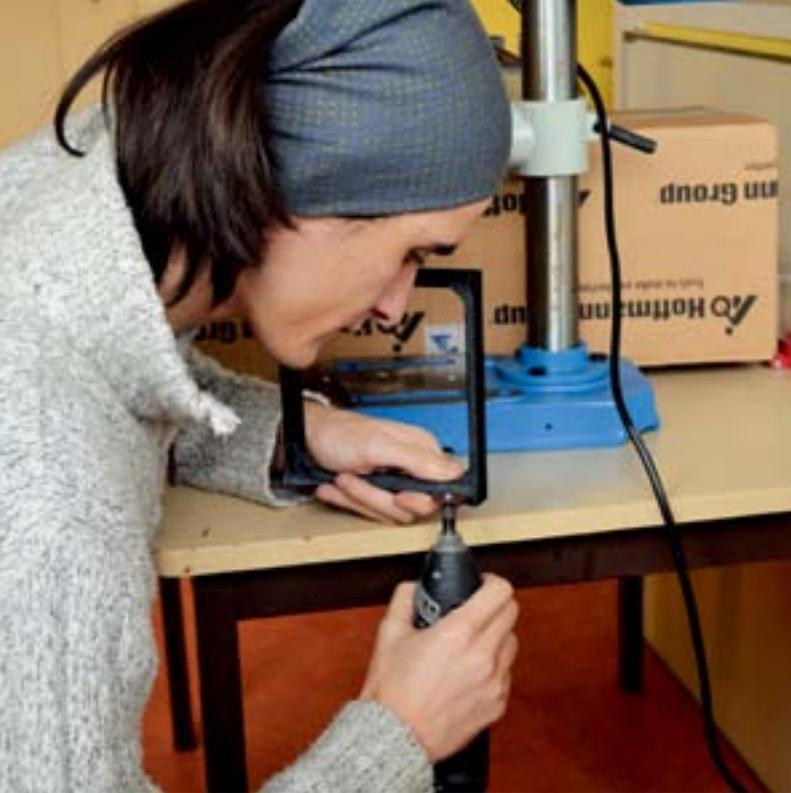
Perçage d'une pièce imprimée
